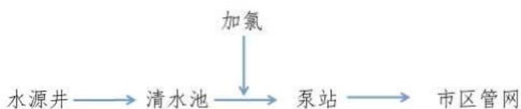
图 2—5 净水工艺流程图
