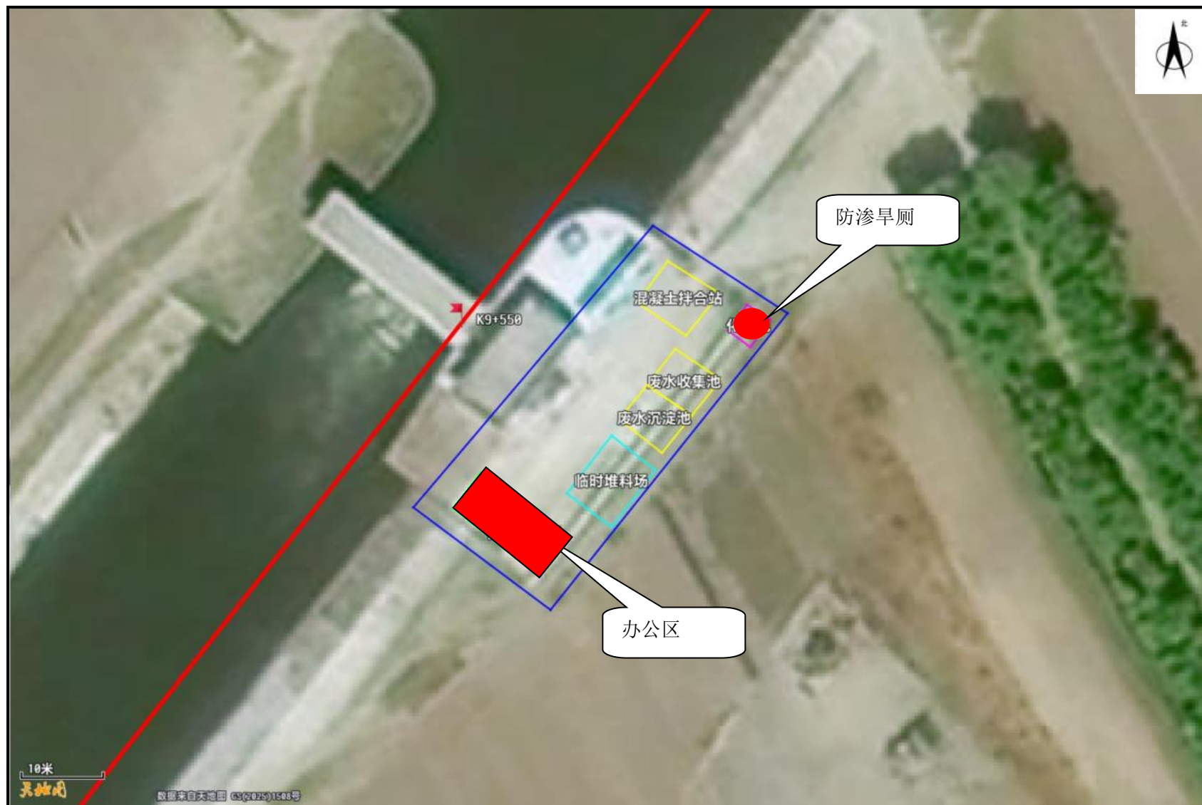
图 4 施工临时占地平面布置图
