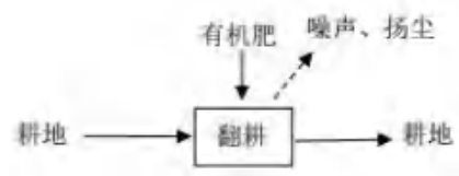
图 2-3 土壤改良工程施工工艺流程及排污节点图
