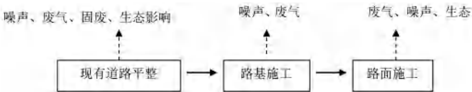
图 2-6 间道路工程施工流程及产排污节点图
