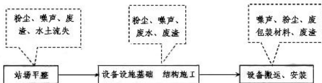
图 5 站场施工工艺流程及产污环节示意图
